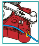
3. Das blaue Kabel läuft durch die Rille nach außen.
