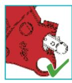
Nach dem Aufsetzen der anderen Hälfte muss der Zugstab so wie in der Abbildung zu sehen sein.
